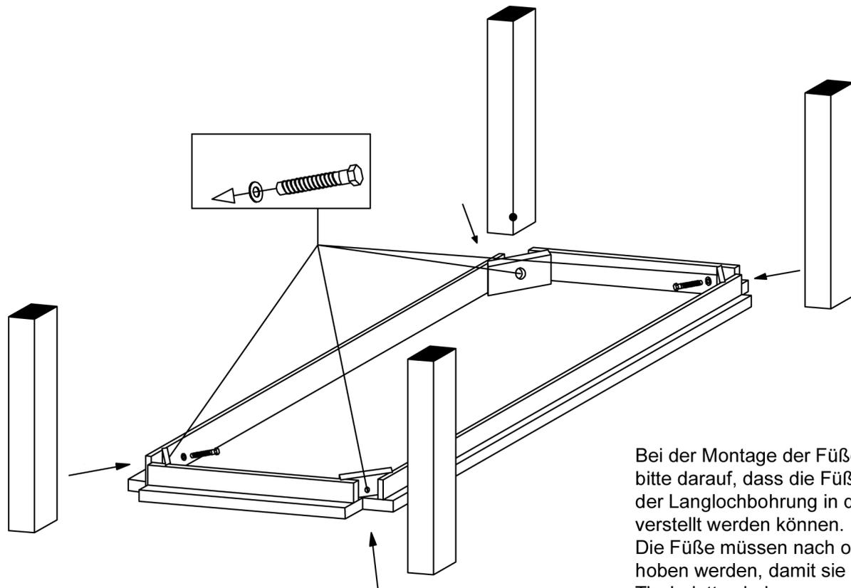
Bei der Montage der FüÙe achten Sie bitte darauf, dass die FüÙe aufgrund der Langlochbohrung in der Höhe verstellt werden können. Die FüÙe müssen nach oben angehoben werden, damit sie eben zur Tischplatte sind.
